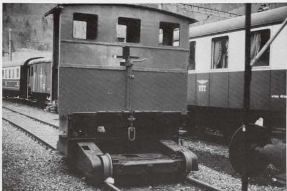
Der Tm 899 des Typs III mit drei Vorwärts- und drei Rückwärtsgängen wird heute beim VVT eingesetzt (Foto U. Hudritsch)
