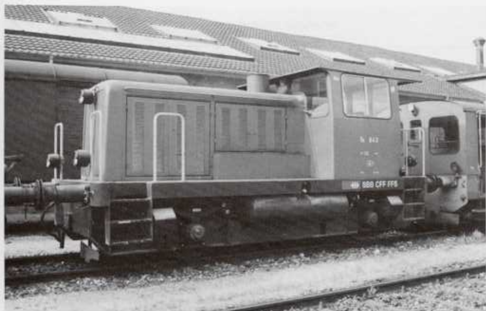
Der Tm 940 für den Einsatz auf Tunnelbaustellen in der HW Olten (Foto F. Roth)
