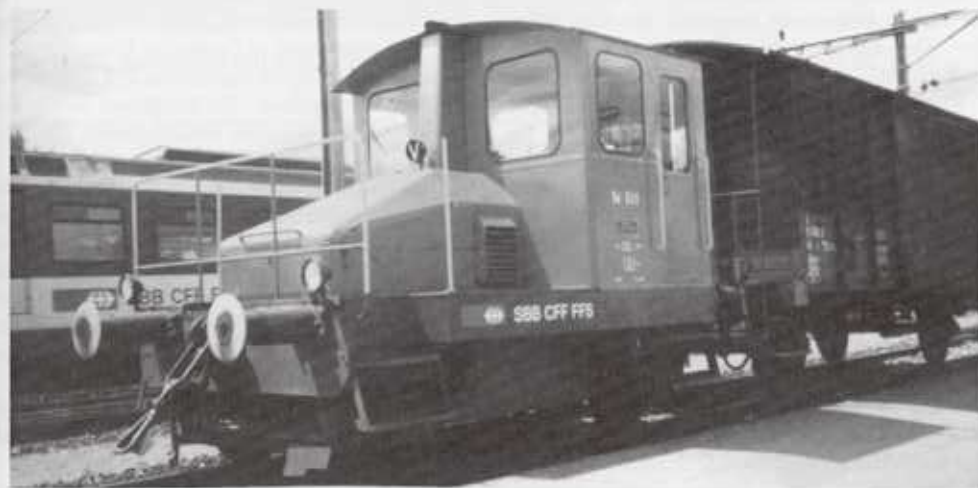
Der Tm I 511 mit Rangierkupplung und aufgesetztem Kamin (Brügg, 25.7.91; Foto M. Klausner)
