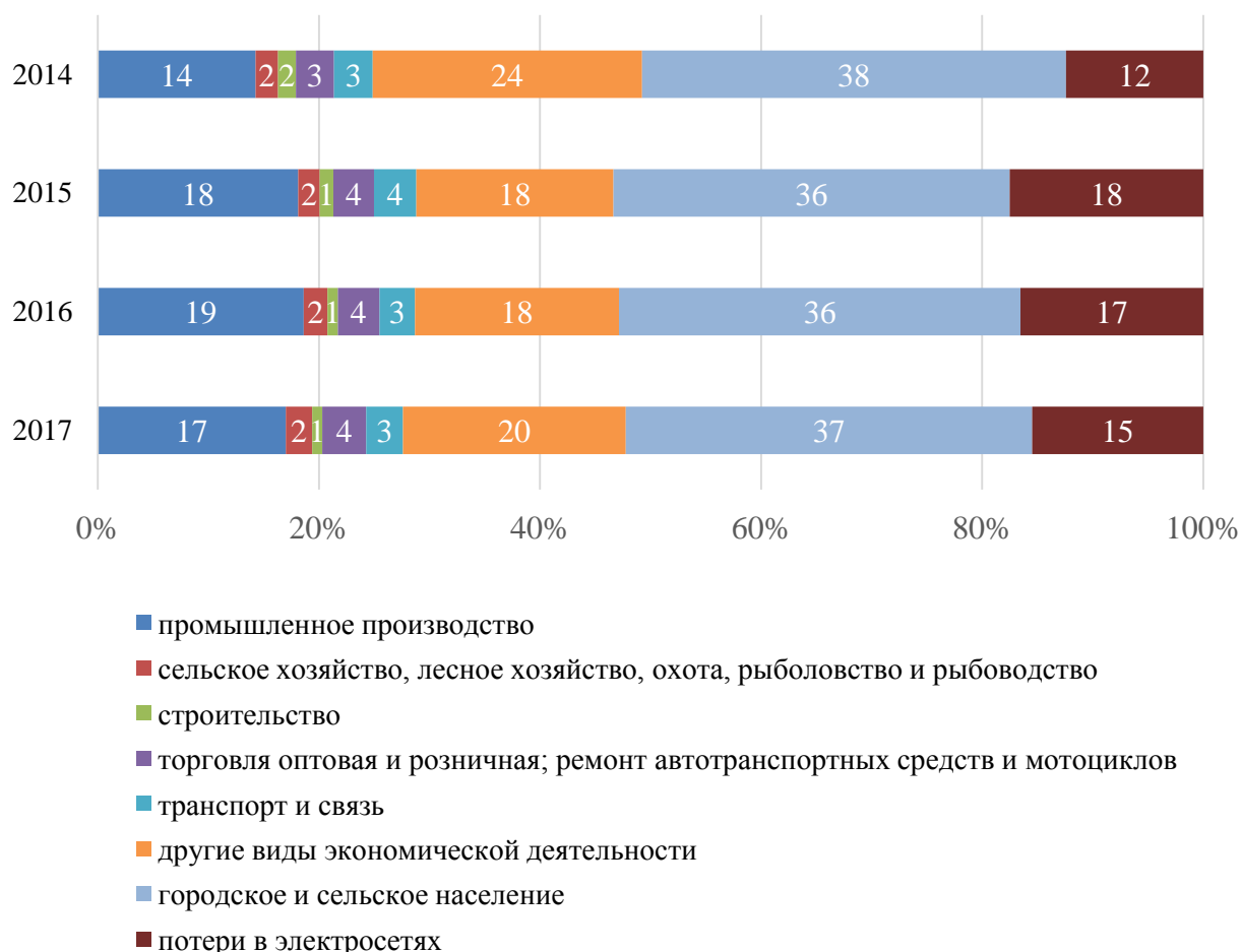
Рисунок 2.3.1 – Структура электропотребления энергосистемы Республики Крым по основным группам потребителей за отчетный период 2013-2017 гг.
