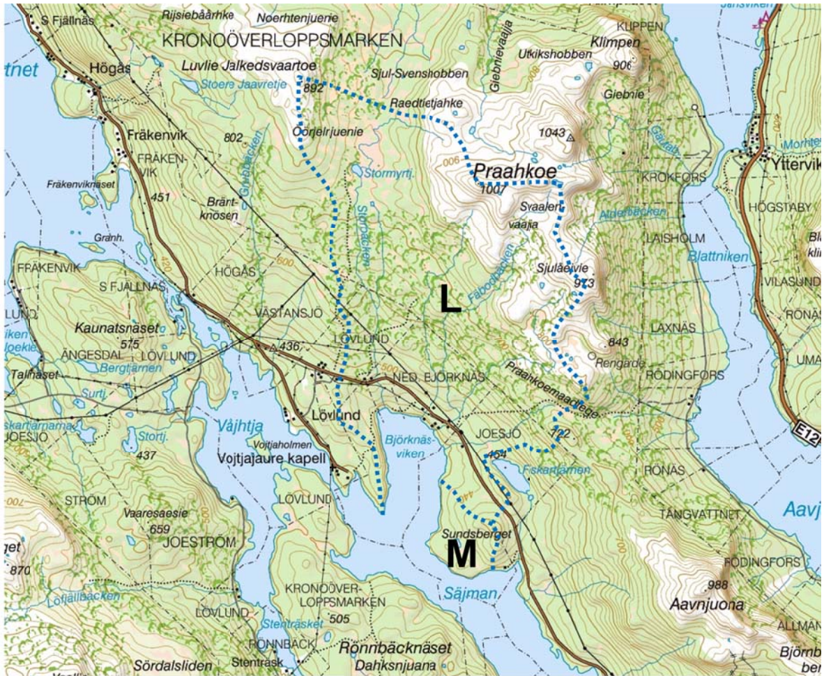
Figur 4-2. Lokala delavrinningsområden (inom blå, prickade linjer och med beteckningarna "L", resp. "M") vilka berörs av den planerade brytningen och anrikningen vid Sundsberget. Motsvarande områden som berörs av den planerade brytningen på Vinberget och Rönnbäcknäset redovisas i Figur 4-3. Tabell 4-3 beskriver dessa områden närmare (©Lantmäteriet Medgivande I2011/1386).
