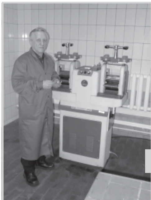
Прокат пластин для изготовления штампованных слитков
