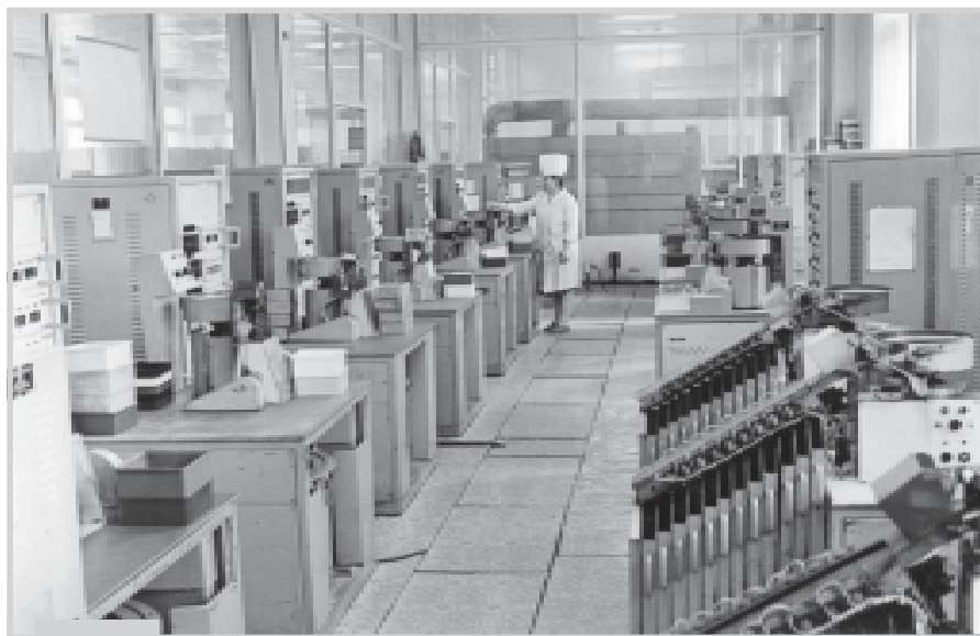
Автоматический участок испытания стабилитронов
