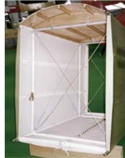
Drahtverspanntes Stahlrohrgitter mit Stoffbespannung (Fokker D-VII)
