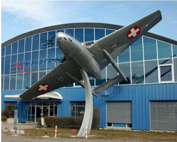
Das Flugzeug DH-100 Vampire wurde durch die Seniorenwerkstatt Buochs speziell konserviert. Alle Öffnungen wurden wasserdicht verschlossen. Im Innern des Flugzeugs wurde ein Entfeuchtungsgerät montiert. Zuletzt wurde das Flugzeug durch die Betriebsgruppe Buochs mit einem Zweikomponentenlack überzogen.
