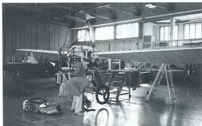
Das Flugzeug fertig verspannt am Kran mit Waage
