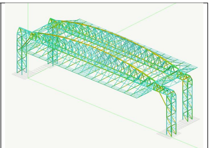
Figura 19 mappatura a colori del fattore di sfruttamento degli elementi
