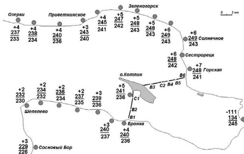
Рисунок 6.1 - Распределение максимумов уровня (см) вдоль побережья восточной части Финского залива при наводнении 9 января 2005 г. при открытом КЗС (знаменатель) и при закрытом (числитель). Показана также абсолютная разность уровней
