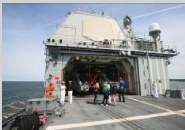
På akterdäck finns helikopterlandningsplats och hangar för två helikoptrar normalt Sikorsky SH-60B eller MH-60R Seahawk LAMPS III
