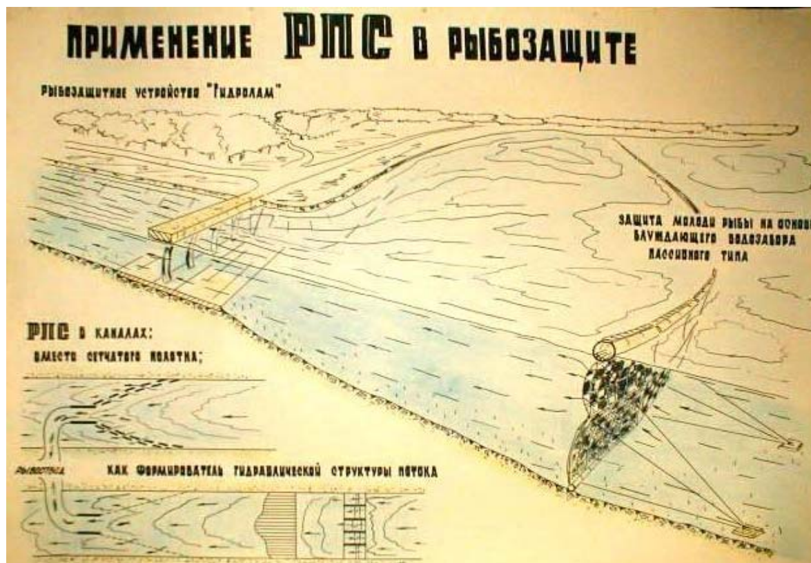
Рис. 3. Новые принципы рыбозащиты от попадания в водозаборы
