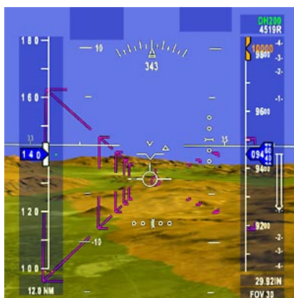
Рис. 2. Пример изображения, формируемого SVS (источник: Universal Avionics Systems Corp.)
