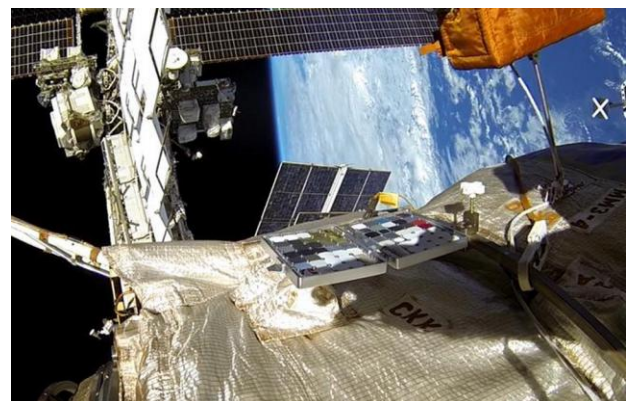
СКК с экспериментальными образцами на внешней поверхности модуля МИМ2
