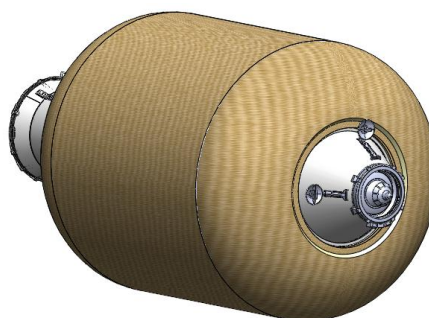
Трансформируемый модуль большого объема, конструктивно сходный с экспериментальным изделием
