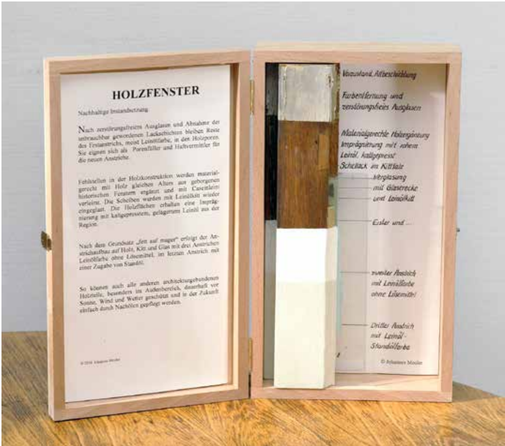
9. Musterprofil: Holzfenster, Instandsetzung und nachhaltige Konservierung. Foto: Johannes Mosler.
