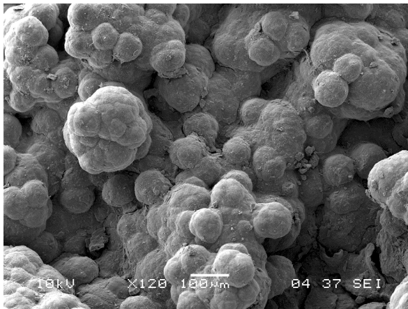
Фото5-8. М-е Сютлийка ф.5- С331. Глобули метаколлоидного опала двух генераций в матрице из сферолитов кристобалита. ф.6. Наноструктуры двух уровней в опале первой генерации С333 ф. 7и 8 - Пятиуровневая иерархическая глобулярная структура опала. ф.281 и 283.
