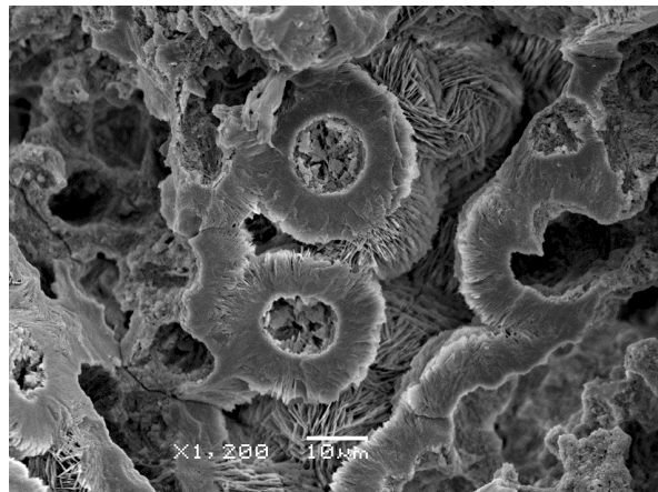
Фото 9-12. ф.9 Метаколлоидный опал двух генераций среди сферолитов халцедона. ф.10 Скол, положительные и отрицательные формы опала первой генерации. ф.11 Метаколлоидный опал двух генераций среди метаколлоидного халцедона. ф.12 Метаколлоидный опал двух генераций инкрустированный сферолитами и леписферами кристобалита.
