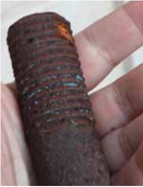
Espárrago de sujeción de la basacarril de un CHE de 15 cm a la explanada.
