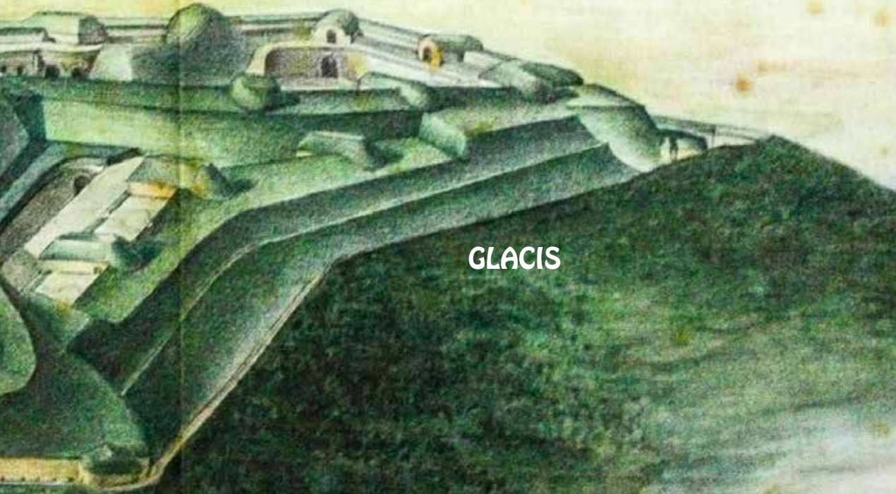
Sección glacis a la altura de la Obra del Centro 1 Camino cubierto. 2 Terraplén (en color rojo) realizado para formar el glacis, el camino cubierto y parte de la contraescarpa. 3 Carretera. 4 Terreno natural. 5 Foso. 6 GLACIS.
