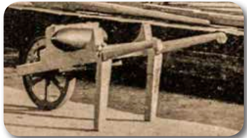
Fotografía de época de una carretilla de mano para municionamiento, cargada con un proyectil de 15 cm.
