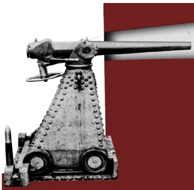
Disposición de un cañón Nordenfelt con montaje de caponera en una cañonera. La explanada es pequeña y sirve para retener las ruedas e impedir el movimiento de retroceso del cañón en el momento del disparo. En el ángulo inferior izquierdo se observa un cartucho.
