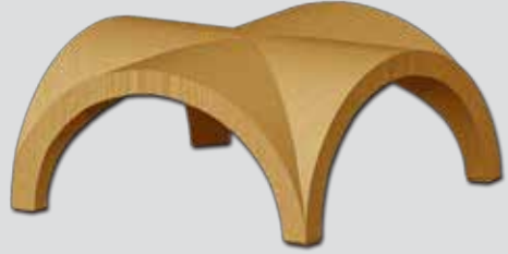
Bóveda de arista
