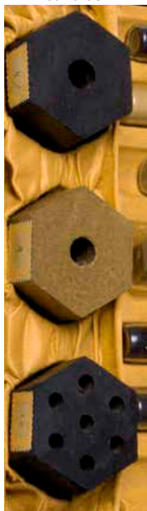
De arriba a abajo pólvora negra y parda de un canal y pólvora negra de siete canales.
