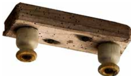
Aisladores de porcelana de una antigua instalación eléctrica del Fuerte.
