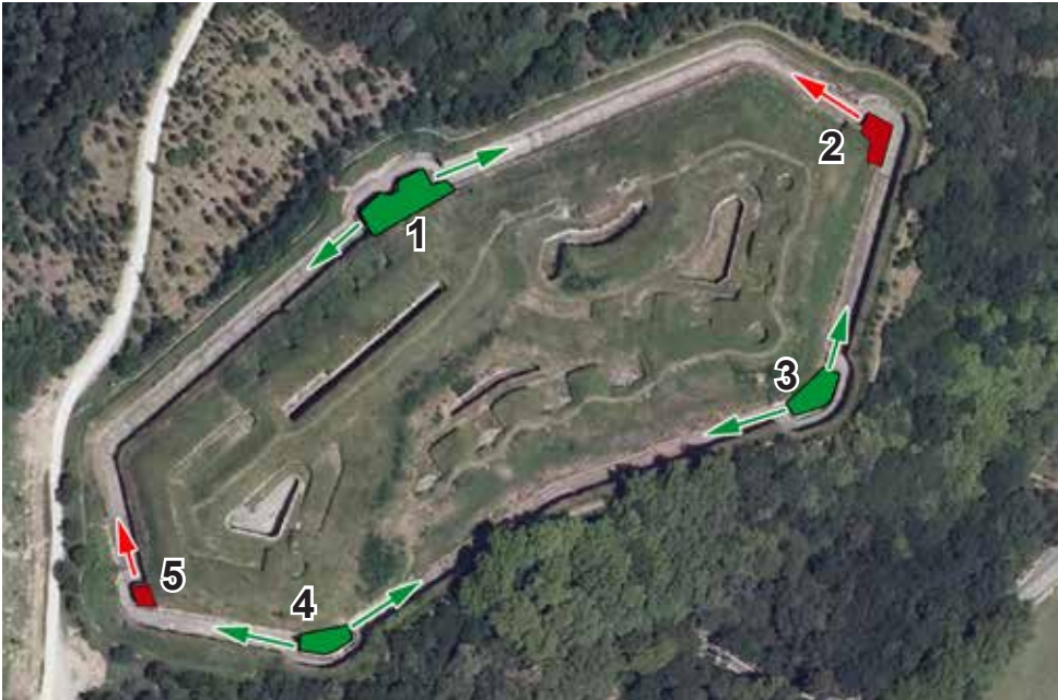
Flanqueo del foso en el fuerte de Guadalupe, encomendado a tres caponeras (color verde) y dos semicaponeras (color rojo). Se han indicado mediante flechas los tramos de foso que defiende longitudinalmente cada una de ellas. 1 caponera de gola. 2 Semicaponera E. 3 caponera SE. 4 caponera SW. 5 semicaponera W.
