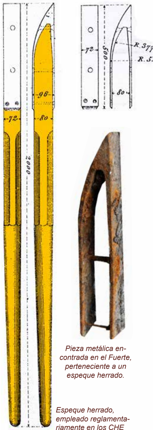
Los servidores apoyan los espeques en el suelo y en el marco de un obús, con objeto de moverlo haciendo palanca.
