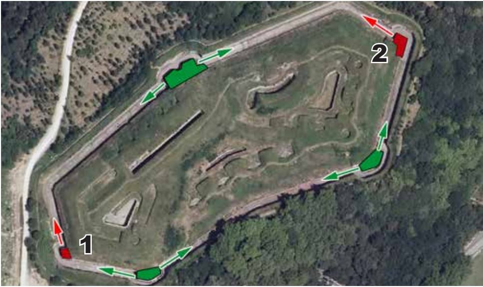
En color rojo están señaladas las semicaponeras oeste (1) y este (2), así como los tramos de foso que flanquean.
