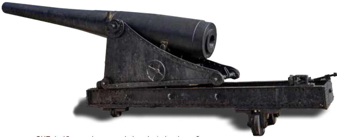
CHE de 15 cm, sobre marco bajo, adaptado a las cañoneras de las casamatas. Fueron tres cañones de esta clase y montaje los que artillaron el fuerte hasta 1911, año en el que se sumó una pieza más.
