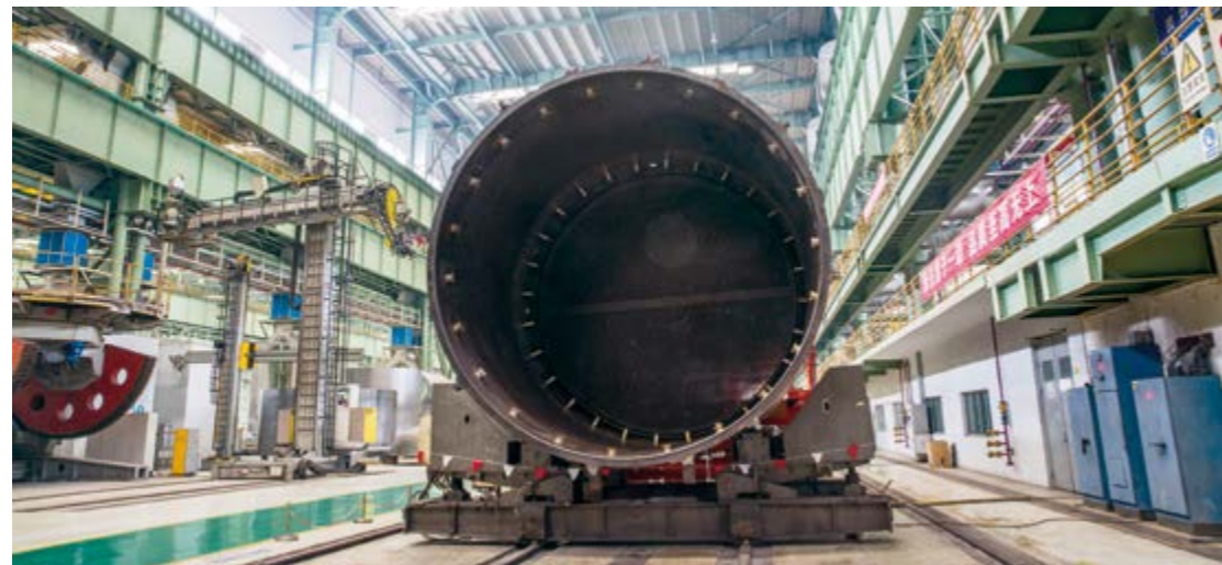
国和一号蒸汽发生器管板
