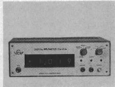
Fig. 2. Digital voltmeter med elektromekanisk indikering av samma typ som visas i fig. 1. Voltmetern, som har typbeteckningen 201, kan användas för likspänningsmätning upp till 1 000 V. Tillverkare: United Systems Corp., USA.
