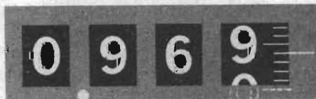
Fig. 1. United Systems Corp., USA, använder i sina digitala mätinstrument elektromekaniska indikeringsenheter i stället för elektroniska med sifferör. Genom att indikeringen sker med servomotorstyrda sifferhjul får man i viss mån analog avläsning av minsta decimalen.
