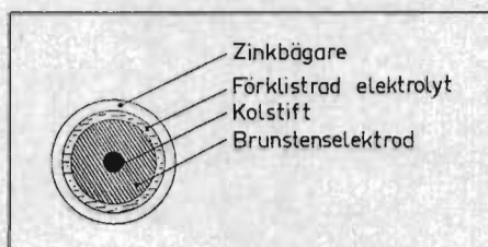
Fig. 2. Principskiss av bägarcell, sedd uppifrån.
