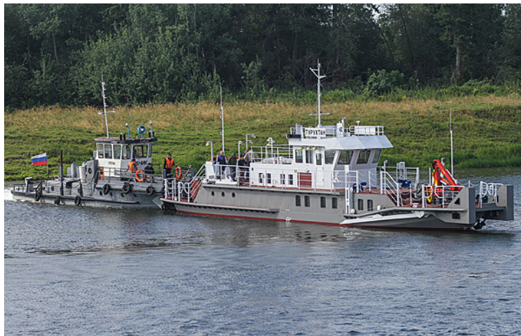
Фото 67. Буксирування методом тяги спеціалізованого судна «ANT TRADER», яке перевозить унікальний великогабаритний великоваговий вантаж - промисловий модуль (див. вище), та буксирування методом штовхання нового, тільки но спущеного на воду великого буксира-штовхача меншим буксиром-штовхачем (див. нижче).
