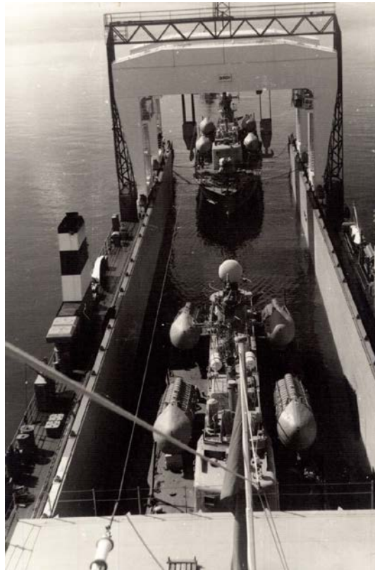
Фото 4. Вивантаження катерів з трюму наплавного судна (типу Ro-Flow ) «СТАХАНОВЕЦ ПЕТРАШ» методом докування з використанням синхронної роботи судових 350-тонних мостових кранів.
