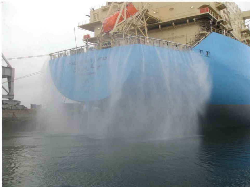
Фото 37. Система водяного захисту від несанкціонованого вторгнення на борт судна.
