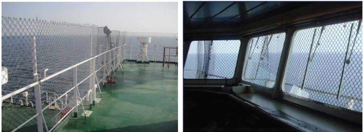
Фото 36. Охоронні огороження і шланги подачі за борт морської води для забезпечення водяного захисту судна.
