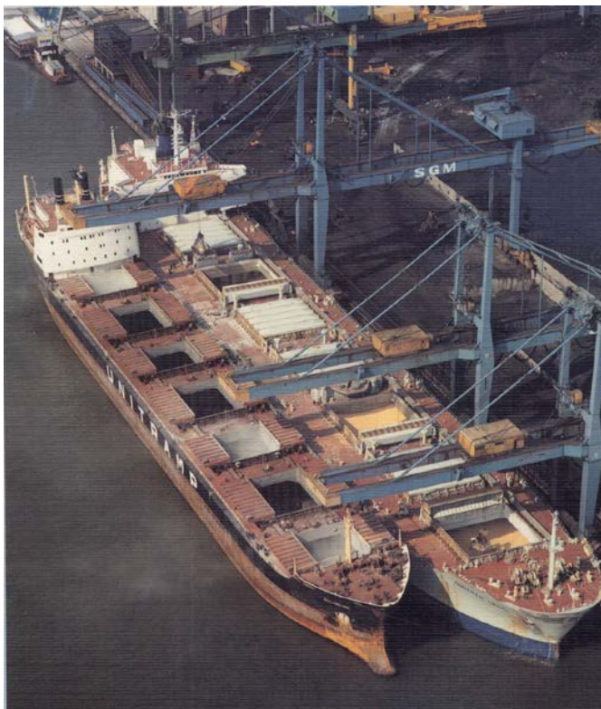
Фото 7. Великотоннажні навалочні судна (балкери) в процесі вантажних операцій, які забезпечуються береговими крановими перевантажувачами типу Gantry на спеціалізованому вантажному терміналі для перевалки навалочних (насипних) вантажів.
