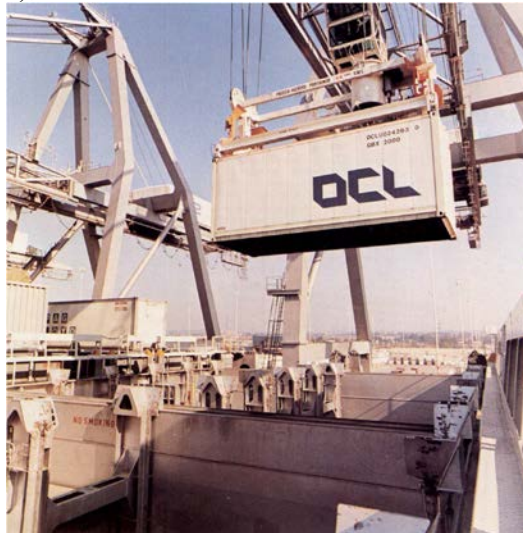
Фото 1. Комірки з направляючими у вантажному трюмі контейнеровозу типу Cellular Container Carrier .
