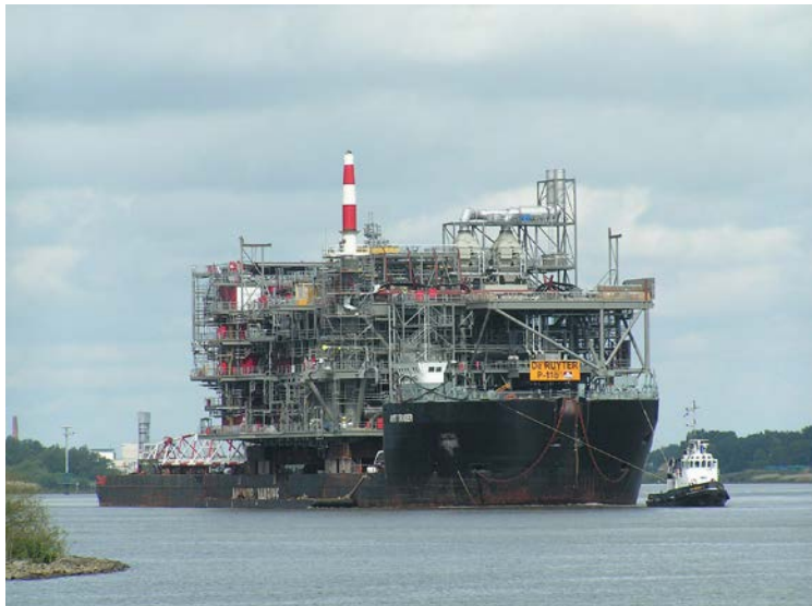
Фото 67. Буксирування методом тяги спеціалізованого судна «ANT TRADER», яке перевозить унікальний великогабаритний великоваговий вантаж - промисловий модуль (див. вище), та буксирування методом штовхання нового, тільки но спущеного на воду великого буксира-штовхача меншим буксиром-штовхачем (див. нижче).
