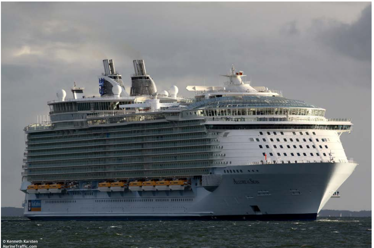
Фото 65. Довжина одного з найбільших у світі круїзних пасажирських суден « ALLURE of the SEAS » становить 360 м, ширина 60 м, а місткість – 6 400 пасажирів, при цьому чисельність екіпажу становить 2 100 осіб.
