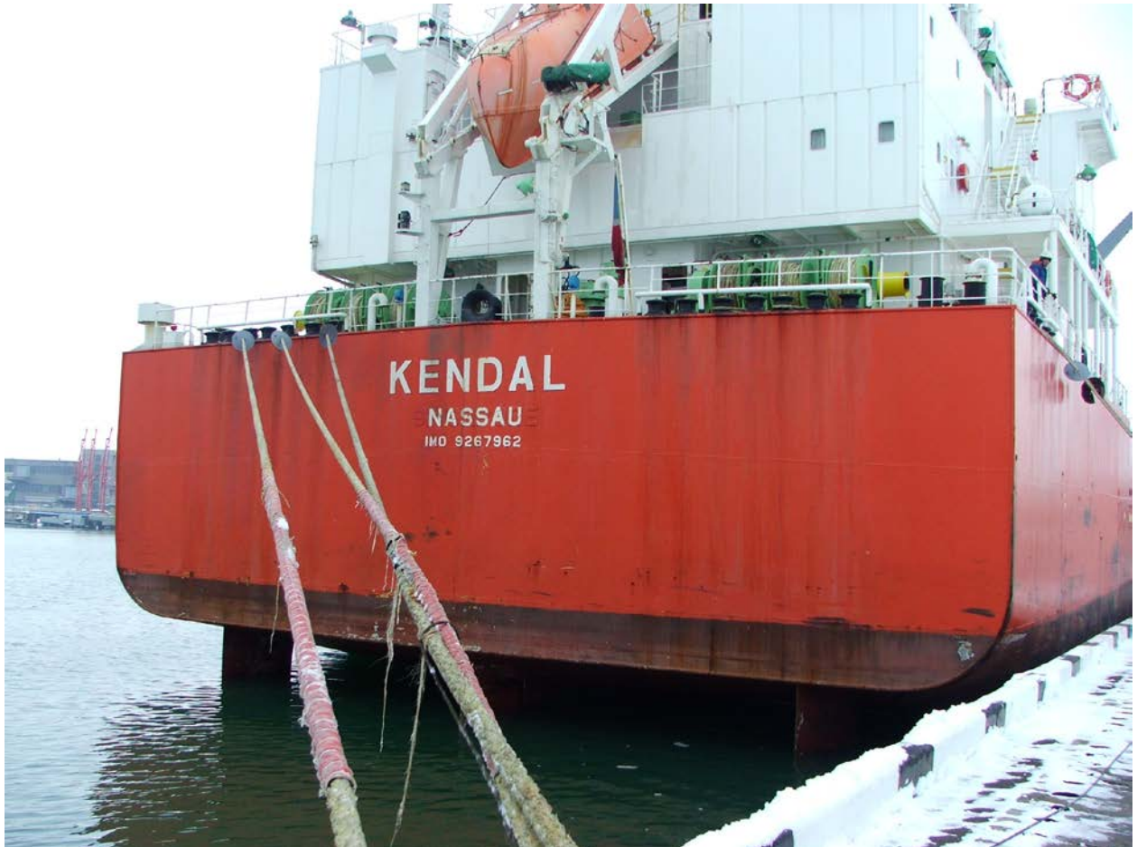
Фото 12. Засоби ідентифікації судна – назва, порт приписки і розпізнавальний номер ІМО: у відповідності з Правилем 3 Глави XI-1 МК СОЛАС-74 з поправками і доповненнями наступних років кожне судно повинно мати розпізнавальний номер, який відповідає системі розпізнавальних номерів ІМО, прийнятих Організацією [Резолюція ІМО А.600(15)], і який наноситься постійно на видному місці на корпусі судна (кормі або на кожному борті на міделі).
