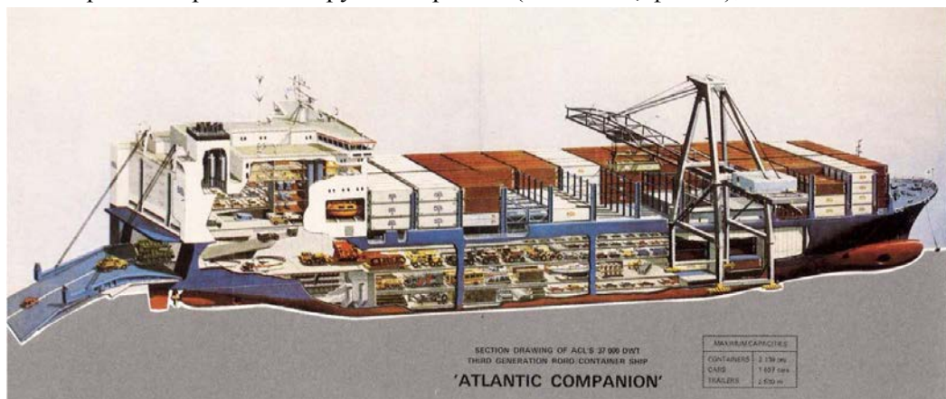
Фото 2. Накатне судно ( Freight Con-Ro carrier ) третього покоління «ATLANTIC COMPANION»: дедвейт 37 000 т, судно може перевозити контейнери 2 139 TEU, 1 607 легкових автомобілів, 2 620 трейлерів.
