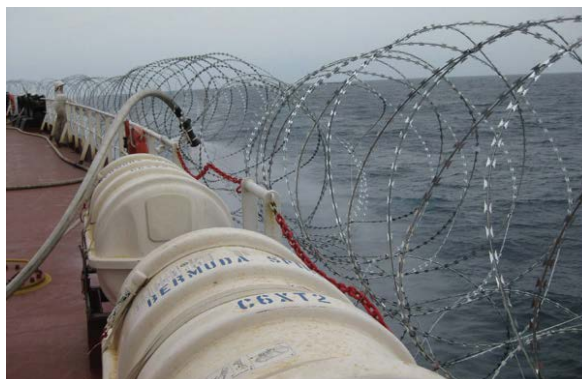
Фото 36. Охоронні огороження і шланги подачі за борт морської води для забезпечення водяного захисту судна.
