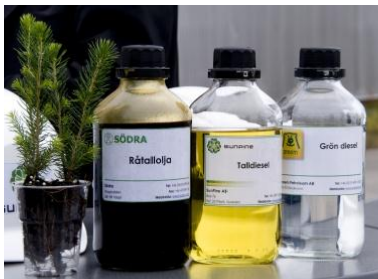
Figur 7. Råttoljan från massabruk ”raffineras till råttaldiesel på Sunpine i Piteå och vidareförädlas till en 20-procentigt grön, homogen diesel hos Preem i Göteborg” (Nyteknik, 2012).
