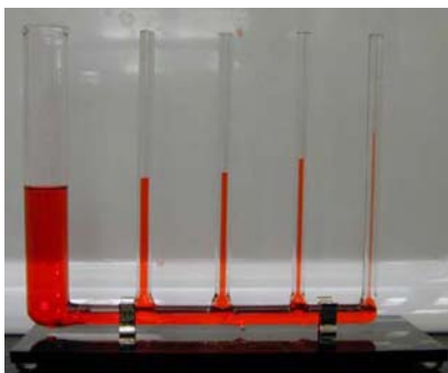
ภาพที่ 1 แสดงระยะดูดของ Capillary ของของเหลวในท่อที่มีขนาดต่าง ๆ
