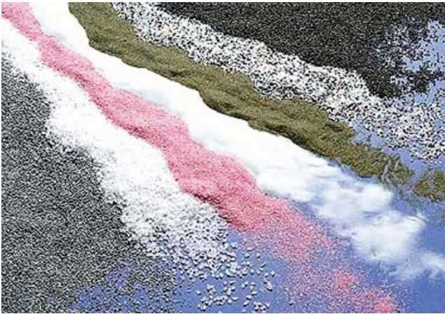
วัสดุขัดแบบผงชนิดต่างๆ (เรียงลำดับจากซ้ายไปขวา) silicon carbide, glass beads, pink fused alumina, sodium bicarbonate (baking soda), brown alumina, zirconia alumina และ slag abrasive (ภาพจาก www.surfacepreparation.com )
