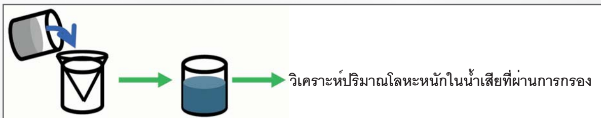
รูปที่ 3 ขั้นตอนการทดสอบลักษณะของโลหะหนักปนเปื้อนในน้ำทิ้ง
