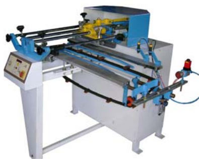
ภาพที่ 1 เครื่อง Flat Screen Printing ของบริษัท SACMI ที่มา : http://www.systemceramic.it
