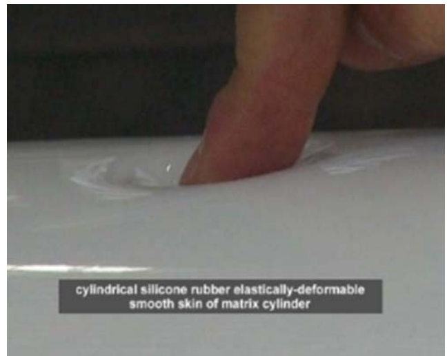
ภาพที่ 5 Cylindrical Silicone Drum ซึ่งมีความยืดหยุ่นสูง ที่มา : http://www.systemceramic.it
