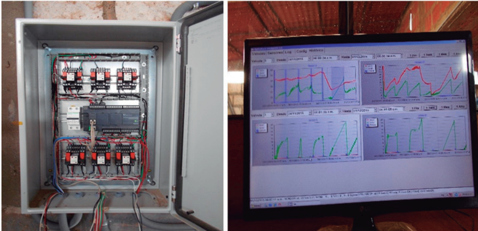
Figura 2. Fotos del PLC y el servidor con el software de gestión y control de riego inteligente
