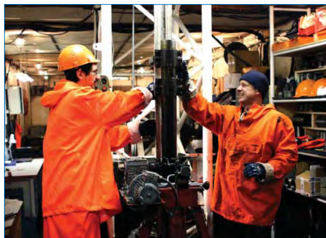
Обслуговування снаряда на буровій станції Восток.
