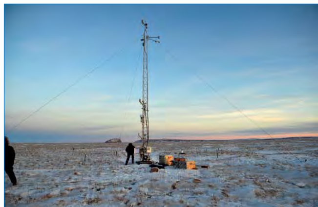
Вышка для регистрации метеопараметров и для наблюдений за эмиссией метана и углекислого газа из тундровых почв в атмосферу.
