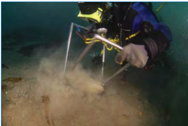
С. Гребельный отбирает пробу зообентоса с помощью зубчатого водолазного пробоотборника Грузова. Фото Н. Гелинаса (НГО).
