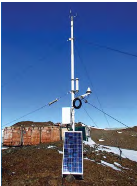
Автоматическая метеорологическая станция MAWS Русская с ультразвуковым датчиком ветра Vaisala WAS425A.
