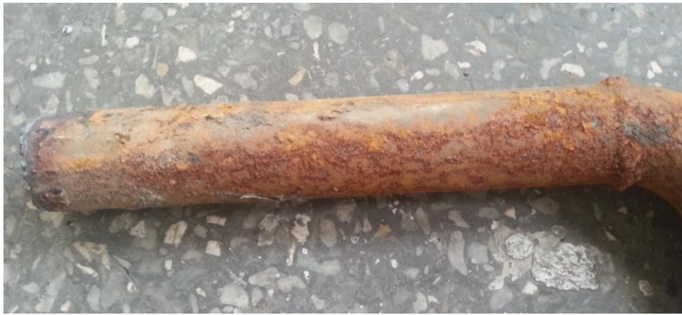
Рис. 19 – Почвенная коррозия металла
