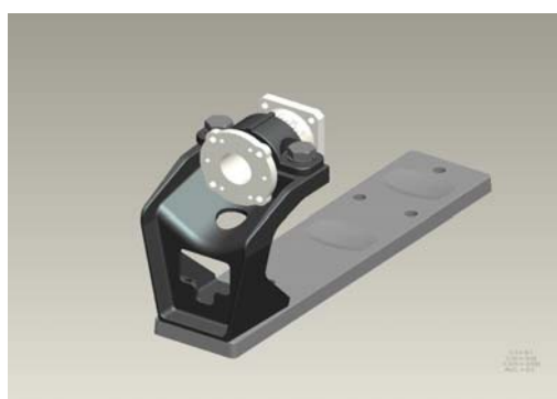
Рис. 3. Общий вид опорной рамы
