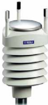
Рис. 8. Внешний вид метеостанции WXT520
