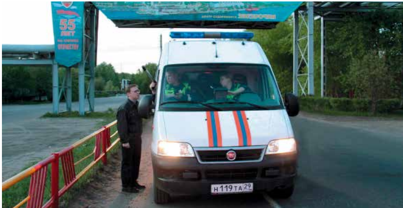
Рис. 5. Передвижная радиометрическая лаборатория Службы спасения Архангельской области (на базе автомобиля «Фиат Дукато»)
