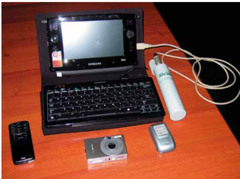
Рис. 2. Пример развертывания автономной системы радиационной разведки на базе второго рабочего места мобильного комплекса
