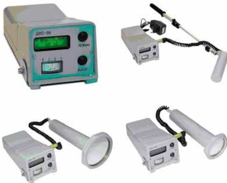
Рис. 17. Внешний вид дозиметра-радиометра ДКС-96
