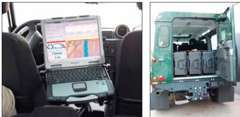
Рис. 11. Размещение ноутбука на специальном кронштейне в салоне (а) и кейсов с оборудованием в багажнике (б) ПРЛ
