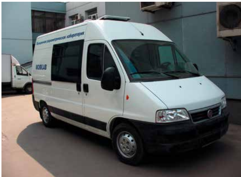
Рис. 9. Внешний вид ПРЛ на базе грузового фургона «Фиат Дукато»
