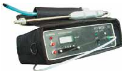
Рис. 21. Внешний вид газоанализатора КОЛИОН-1В
