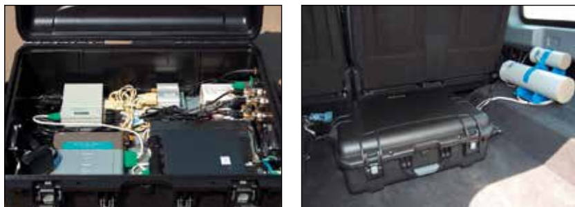
Рис. 12. Размещение активного оборудования (а) и блоков детектирования в багажнике ПРЛ (б)
