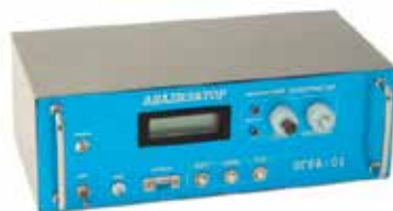
Рис. 23. Внешний вид газоанализатора ЭГРА-01
