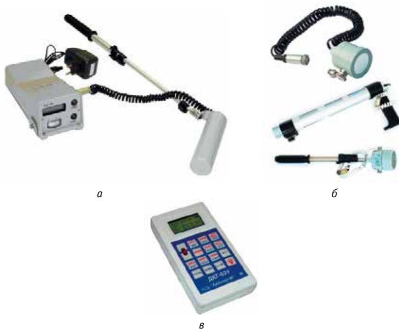
Рис. 4. Радиометрическое и дозиметрическое оборудование ПРЛ: а — дозиметр-радиометр ДКС-96М с гамма- датчиком; б — сменные блоки детектирования к ДКС-96: БДЗА-96т, БДПГ-96, БДКС-96с; в — дозиметр ДКГ-02У «Арбитр»
