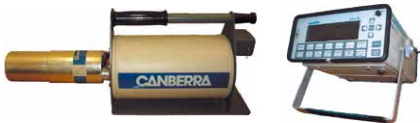
Рис. 2. Полупроводниковый детектор и многоканальный анализатор «Canberra»
