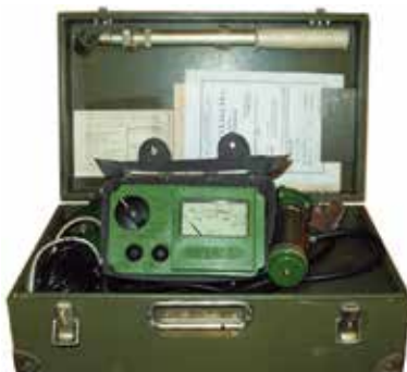
Рис. 19. Внешний вид дозиметра ДП-5
