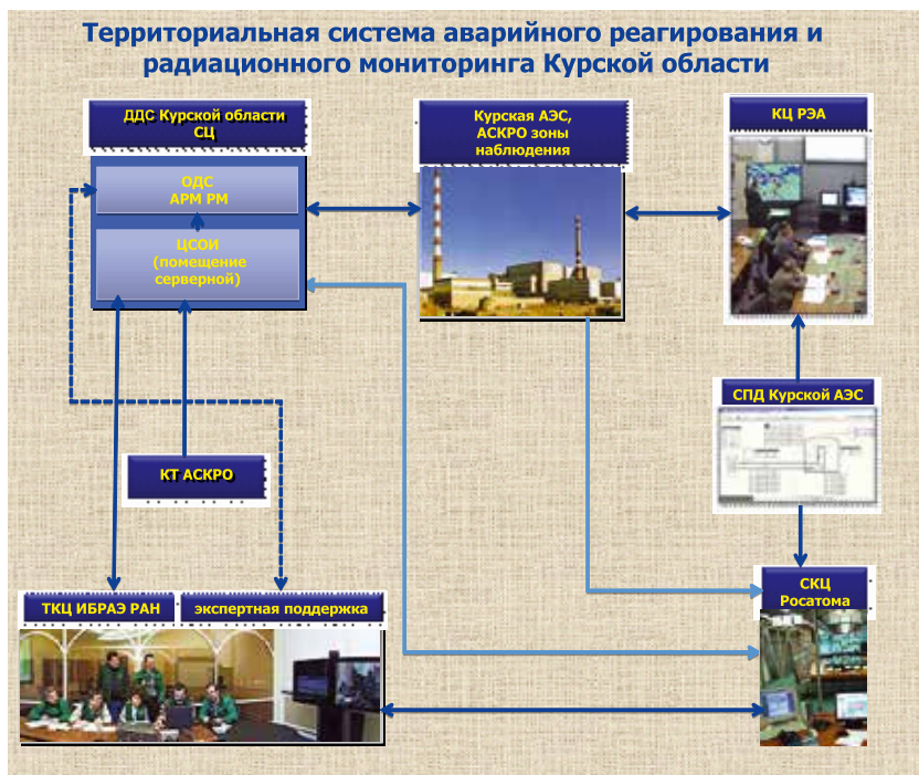
Рис. 1. Функциональная схема системы аварийного реагирования Курской области (КЦ РЭА — Кризисный центр Концерна «Росэнергоатом», СПД — система передачи данных)
