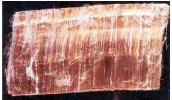
شكل A.100a معدن الأسبستوس نوع من معدن السرينتاين ينمو كخيوط قطنية الشكل وناعمة، يمكن فصلها ونسجها كنسيج مقاوم للنار. لاحظ أن الأسبستوس من المعادن التي لاتشكل أوجه بلورية جيدة الهيئة Skinner & Porter, 1987
