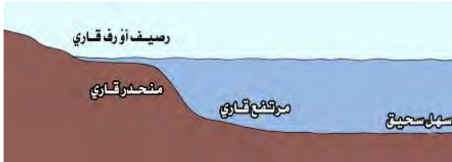
شكل C.132a مقطع عرضي لتضاريس الحافة القارية يوضح الرصيف، والمنحدر و المرتفع القاري Montgomery, 1993
