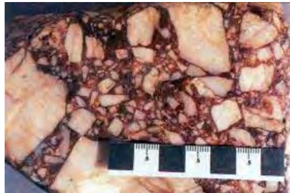
شكل B.110c راهصة أو بريشة مميزة بشظايا أو كسر مزواة، لاحظ اللام في الصخر ملون بالهيماتايت Plummer & McGeary, 1993
