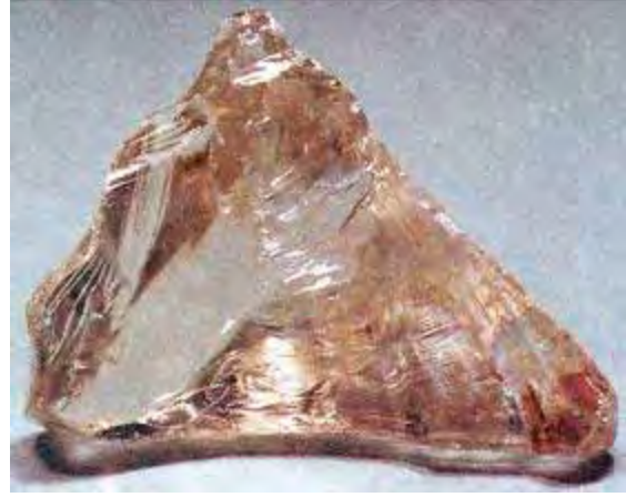
شكل C.117b مكسر محاري أو زجاجي، تنتج الأسطح الملساء عندما تنكسر المعادن بشكل هيئة الزجاج Tarbuck & Lutgens, 1997
