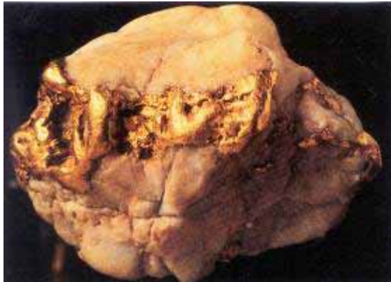
شكل F.76a تكوين الشذرة. عرق من الذهب الفلزي قاطع خلال حصى من الكوارتز العرقى، طول العينة ٤ سنتيمترات Skinner & Porter, 1987
