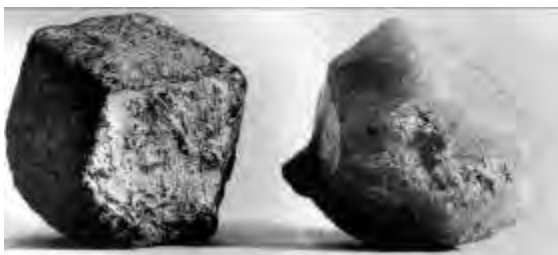
شكل G.7c بلورات لمعدن الجارنت تظهر خاصية الشكل المتساوي أو المكعب Birkeland &amp; Larson, 1978
