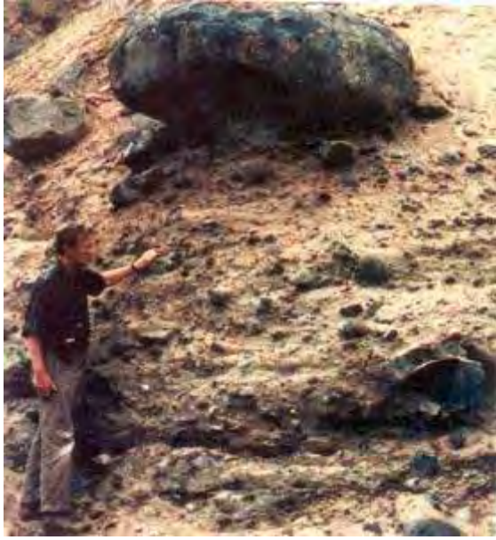
شكل G.38b رواسب متلجية حريث جلمودي في نهاية ركام جليدي لمجلدة ألبية، تظهر مدى واسعاً من أحجام الحبيبات و عديم الفرز Skinner & Porter, 1987
