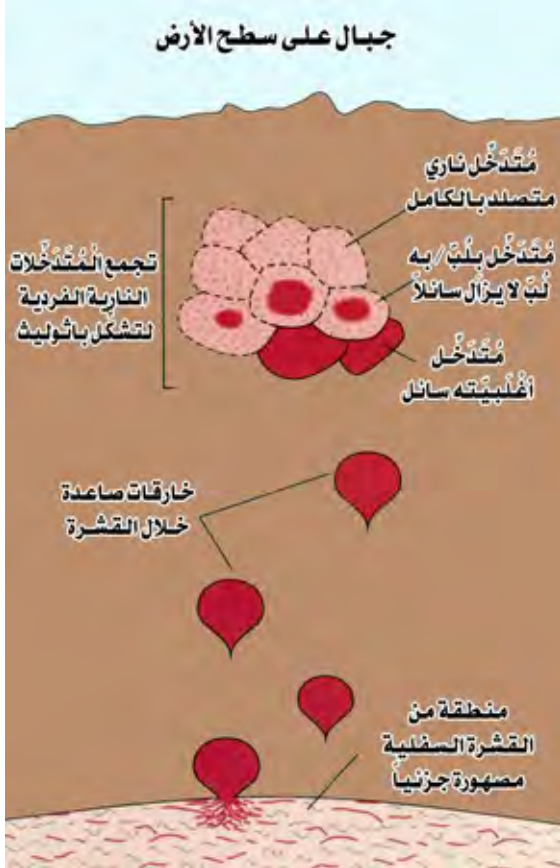
شكل D.46 إختراقات قبوية شبيهة بالفقاعات من الصهارة تنتقل لأعلى من القشرة الأرضية السفلى وتتصلب في القشرة الأرضية العليا Plummer & McGeary, 1993
