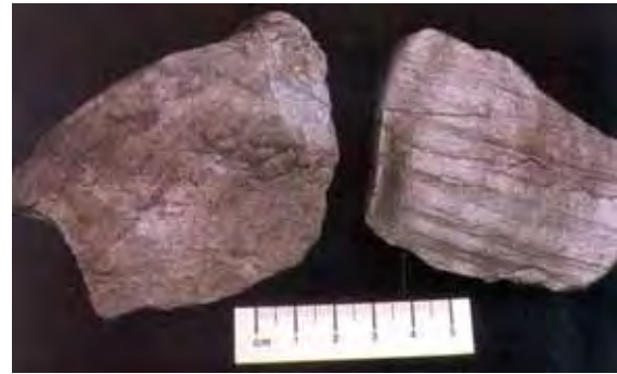
شكل P.61d صخر الفيللايت مظهرأ سطحاً لمعاً بسبب قشور المايكا المتوازية Montgomery, 1993
