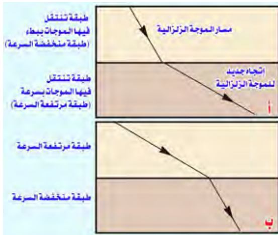
شكل S.76b يحدث الانكسار السيزمي أو الزلزالي، عندما تنتقل الموجات السيزمية حيث تعبر الحدود الصخرية، وذلك من طبقة منخفضة السرعة إلى طبقة عالية السرعة أو العكس Plummer & McGeary, 1993
