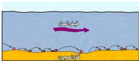
شكل S.3a رسمه خطية لقفز أو لنط الحبيبات Saltation تنتقل الحبيبات الأثقل في مجموعات أو سلسلة ذات نطات قصيرة، تتدافع لأعلى نحو الماء المنساب ثم تغرق مرة أخرى باتجاه القاع Montgomery, 1993
