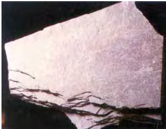
شكل S.141a إردواز موضحاً إستمرارية النمو المعدني الذي يحدث أثناء التحول. هنا يندر رؤية الحبيبات المعدنية Skinner & Porter, 1987
