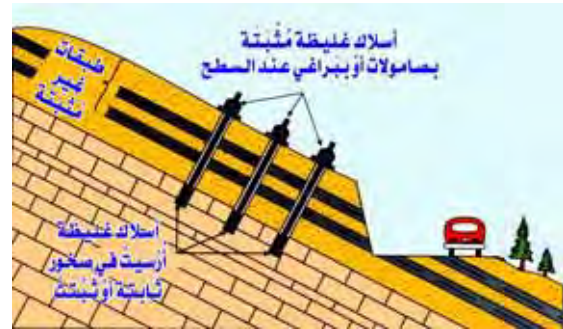
شكل R.78 تستخدم المزاليح أو الأقفال الصخرية في تثبيت الإنزلاق الصخري Montgomery, 1993
