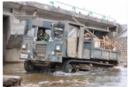
資材運搬車(瓦礫の運搬【東日本大震災】)
