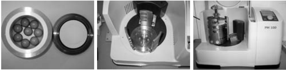
Figura 22.3. Molí de boles (Retsch PM100) utilitzat actualment al laboratori de l'ESAB per assegurar que no es contaminen les mostres
