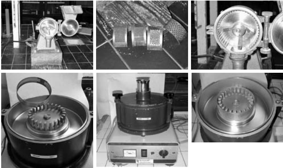
Figura 22.1. Tipus de molí utilitzables per a la mòlta de mostres de compost
