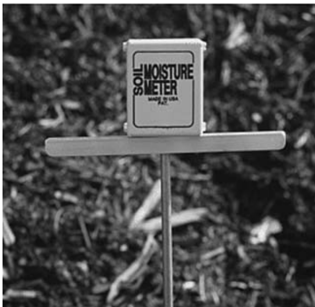
Figura 20.4. Aspecte d'una sonda de determinació de la humitat en piles de compostatge (Reotemp Compost Moisture Meter, http://www.biconet.com/compost/moisturemeter.html )
