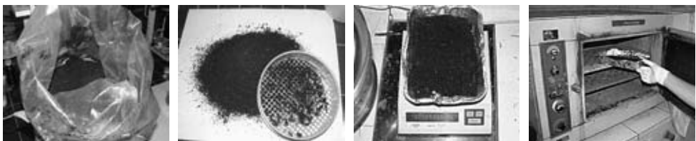
Figura 34.1. Preparació de la mostra per a la realització del test d'autoescalfament
