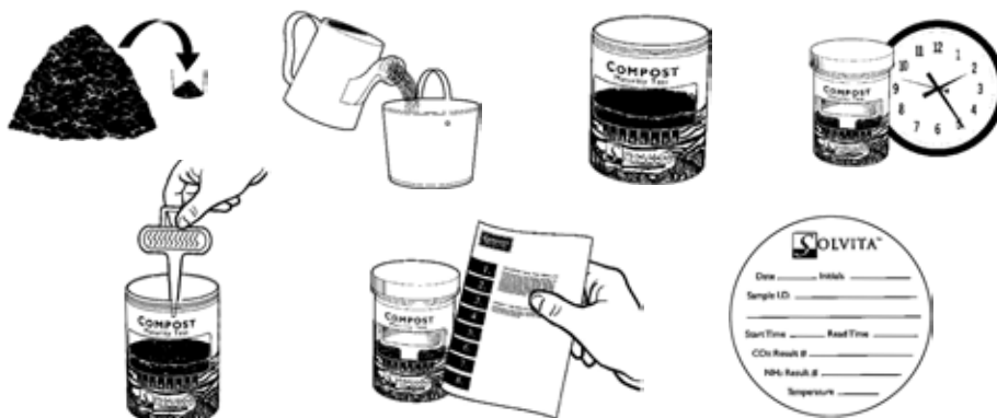
Figura 33.2. Preparació del test segons Woods End Research Laboratory
