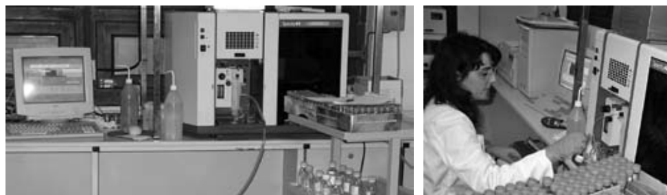
Figura 28.3. Espectròmetre d'absorció atòmica i lectura de les mostres i els patrons
