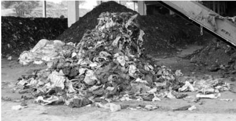
Figura 2.4.14. Rebuig de mig procés
