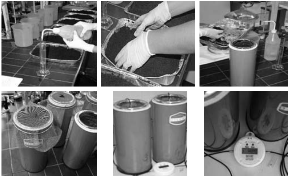
Figura 34.2. Realització del test d'autoescalfament
