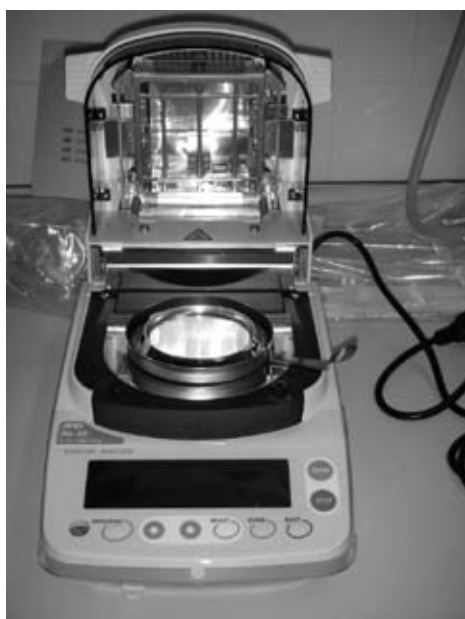
Figura 20.3. Balança d'assecat per infrarojos
