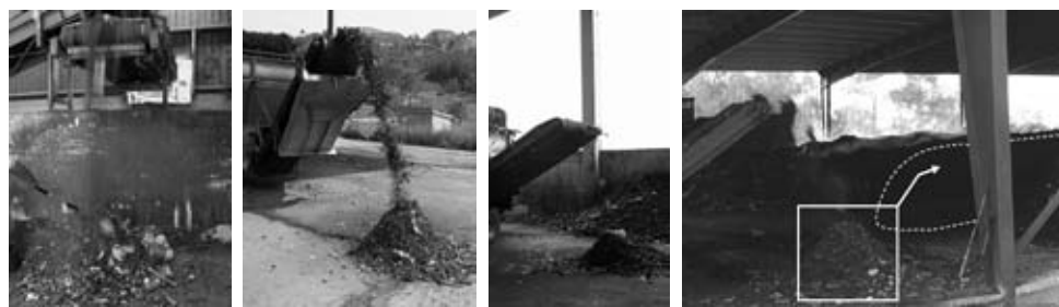
Figura 2.4.11. Presa de mostres de materials en moviment
