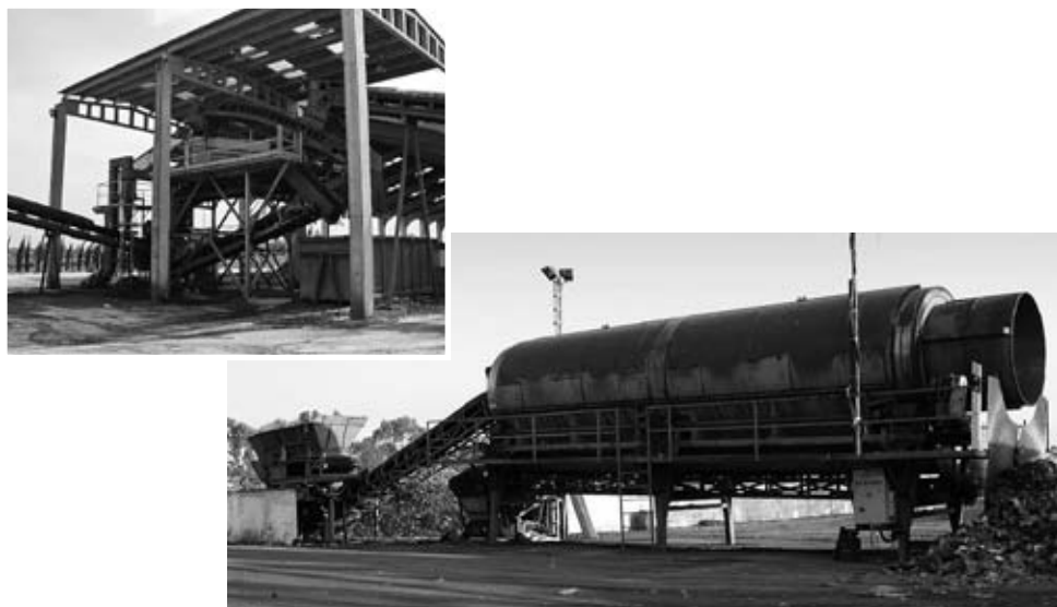
Figura 2.4.9. Sistemes complicats de separació d'impropis necessaris si no es fa la recollida selectiva en origen
