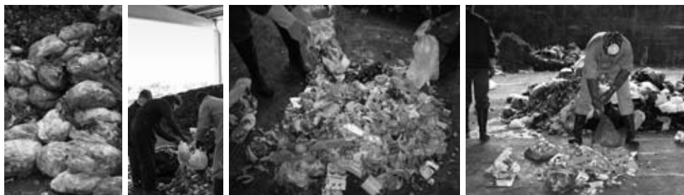
Figura 2.4.7. Obertura de mostres de fracció orgànica per fer la presa de mostres
