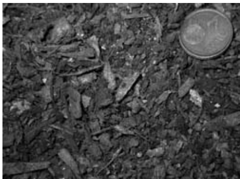
Figura 2.4.19. Rebuig de taula densimètrica amb mal funcionament
