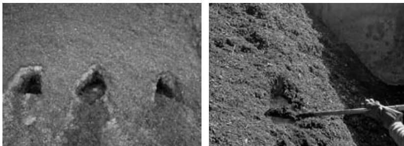
Figura 2.3.2. Detall de punts de mostreig i presa de submostres
