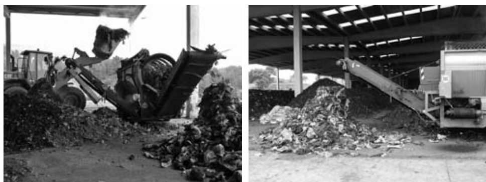
Figura 2.4.13. Separació d'impropis després de la fase de descomposició
