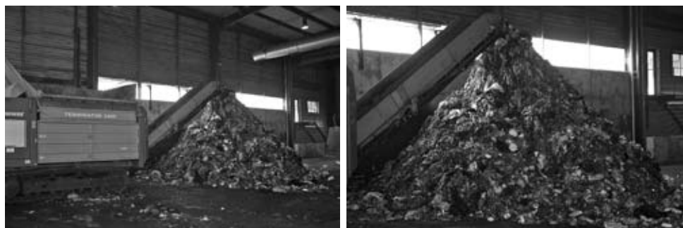
Figura 2.4.8. Presa de mostres després d'un sistema d'obertura i homogeneïtzació del material
