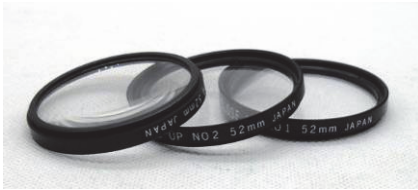
Рис. 2. Макролінзи. Комплект з трьох лінз різного збільшення. Фото автора.
