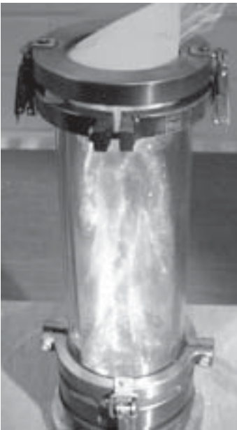
Die simulierte Mehlstaubexplosion
