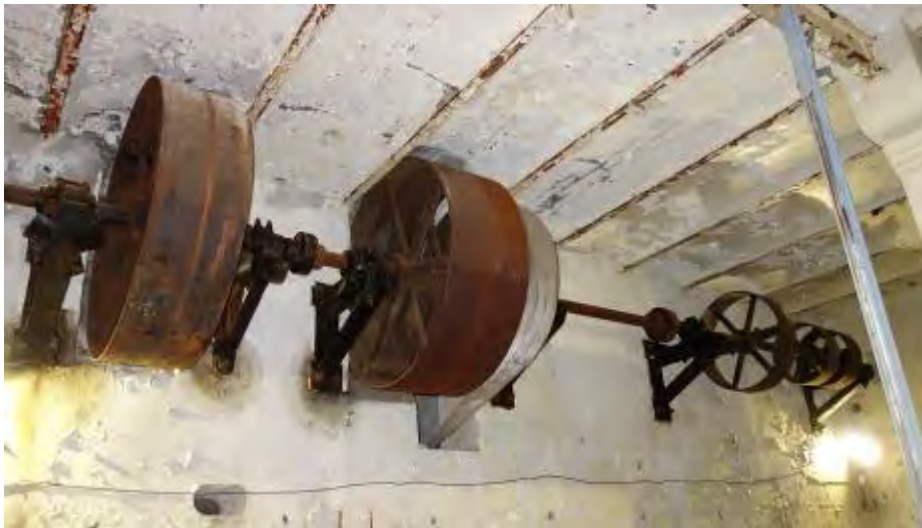
Detailopname aandrijvingen tegen de oostwand van de ruimte 0.5.
