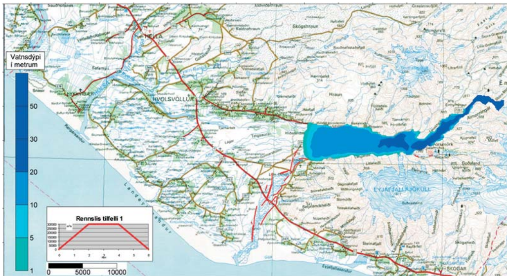
Mynd 16. Hamfarahlaup með hámarksrennsli 300.000 m 3 /s. Myndin sýnir útbreiðslu og dýpi blaups 2,5 klst eftir að það kemur undan Entujökli. Manningstala, n=0.1 \text{ m}^{-1/3}\text{s} (sjá kafla XII) 11
