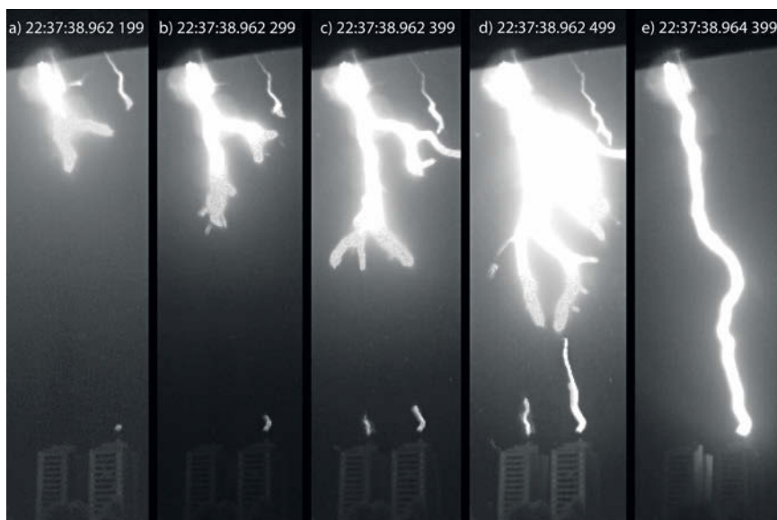
◇ 4. Kiirkaamera kaadritel on näha laskuv liider ja tornmaja katusest vallandunud tõusvad liidrid. Esimese nelja kaadri ajaline vahe on 0,1 tuhandiksekundit. Viimasel kaadril on näha liidrite kohtumisele järgnenud vastulöök
