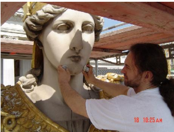
Abbildung 4: Ultraschall-Laufzeitmessung zur Bestimmung des Verwitterungsgrades von Naturstein
