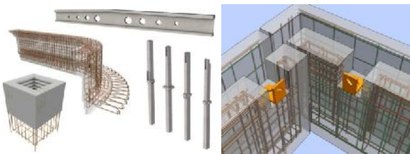
Abbildung 8: Beton-Fertigteilplanung mit BIM
