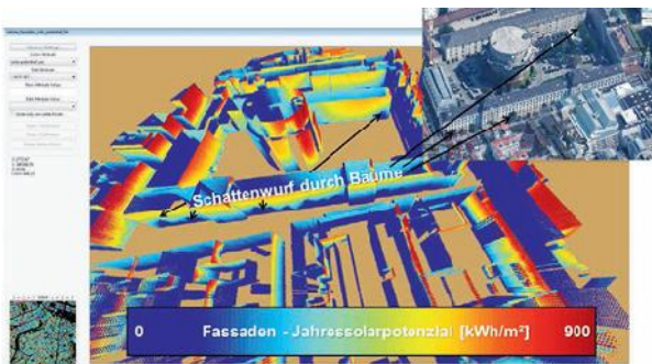
Abbildung 1: Einstrahlungsberechnung: Im Wiener 3D-Modell wurden Fassadenpolygone erzeugt und Exposition und Neigung bestimmt
