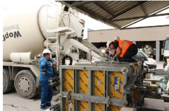
Abbildung 1: Herstellung der Probekörper
