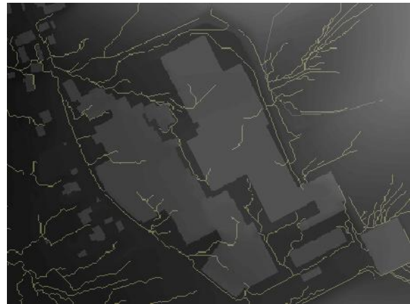
Abbildung 1: Digitales Geländemodell (DGM) mit berechneter Wasserkumulation
