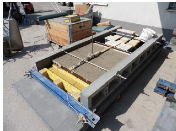
Abbildung 2: Mit Messtechnik versehenes Plattenelement mit den Abmessungen 1/1/0,2 Meter
