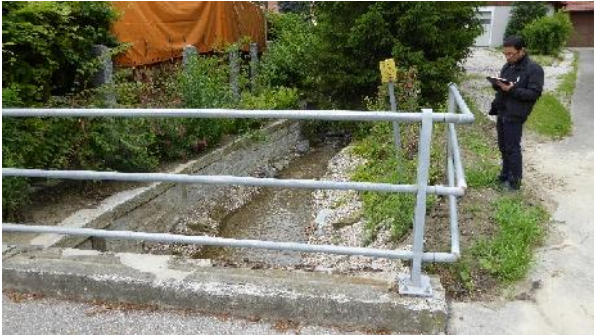
Abbildung 2: Erfassen einer Rohrdurchführung (Linien-element) sowie von Hangwasserdaten vor Ort
