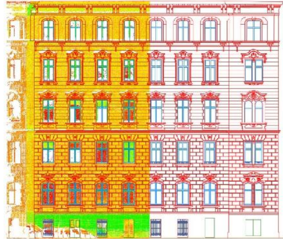
Abbildung 1: Laserscan einer Fassade gemeinsam mit der daraus abgeleiteten Fassaden-Strichzeichnung
