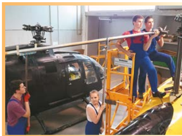
Demontaż łopaty wirnika w śmigłowcu podczas praktyki zawodowej
