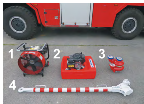
SPECIÁLNÍ PŘÍSLUŠENSTVÍ AUTOMOBILU: 1) PŘETLAKOVÝ VENTILÁTOR, 2) PLOVOUNÍ ČERPADLO, 3) TURBINOVÉ ČERPADLO, 4) VLEČNÁ TYČ PRO TRAMVAJE
