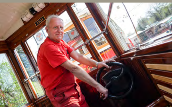
ZDENĚK CHMELÍK U ZVLÁŠTNOSTI TOHOTO KRASINA – SVISLÉHO KOLA OVLÁDÁNÍ RUČNÍ BRZDY
