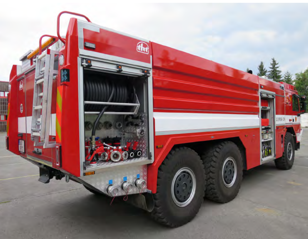
V PRAVÉ ZADNÍ SKŘÍNI JE UMÍSTĚN NAVIJÁK VYSOKOTLAKÉHO HASIČÍHO ZAŘÍZENÍ
