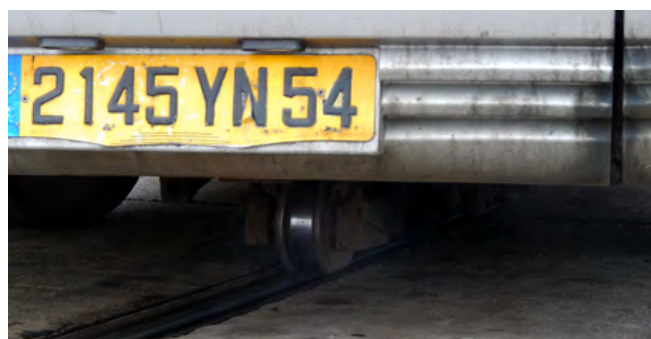
DETAIL VODICÍHO KOLEČKA V ZADNÍ ČÁSTI VOZU. STEJNÝCH KOLEČEK MÁ KAŽDÝ VŮZ NĚKOLIK
