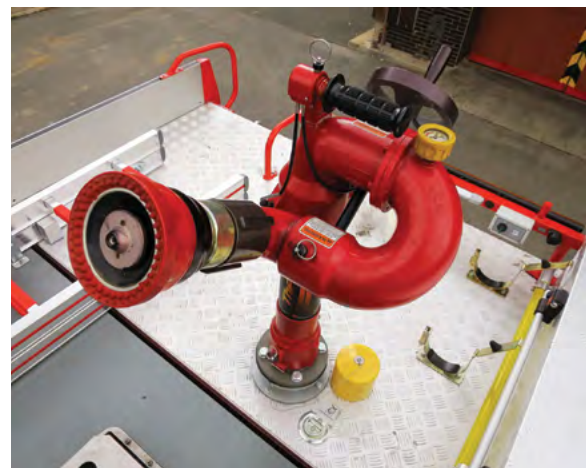
ODNÍMATELNÁ LAFETOVÁ PROUDNICE STINGER, TZV. VODNÍ DĚLO
