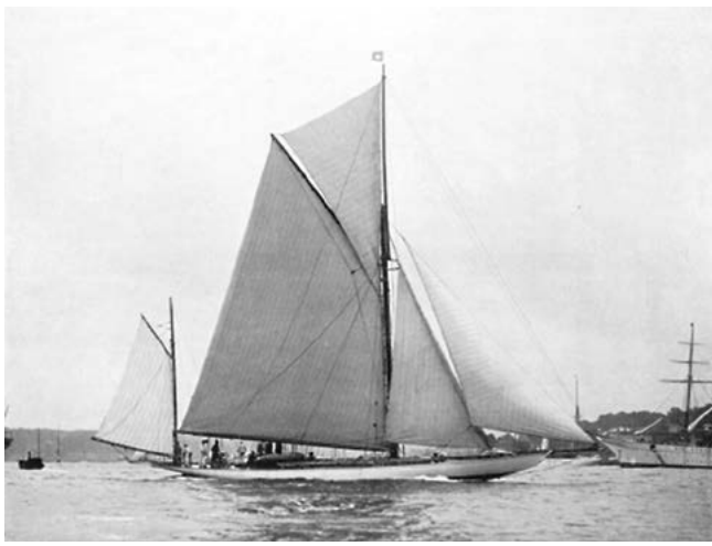
Парусное вооружение иол долго оставалось очень популярным для крейсерских яхт
