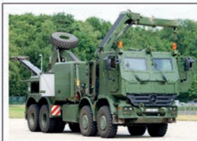
Mercedes-Benz Typ Acros 4151AK 8x8 (Bison) mit Hiab Kran Typ 2222 ATF1 und Bergeinrichtung der Firma Empl Typ EH/W200.
