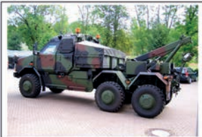
das Bergefahrzeug besitzt eine hydraulische Bergwinde für Fahrzeuge bis 14t.
