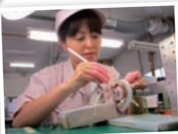
防卫装备制造公司生产车长用潜望镜和炮手用潜望镜零件的解角器(角度传感器)的线圈的情景
