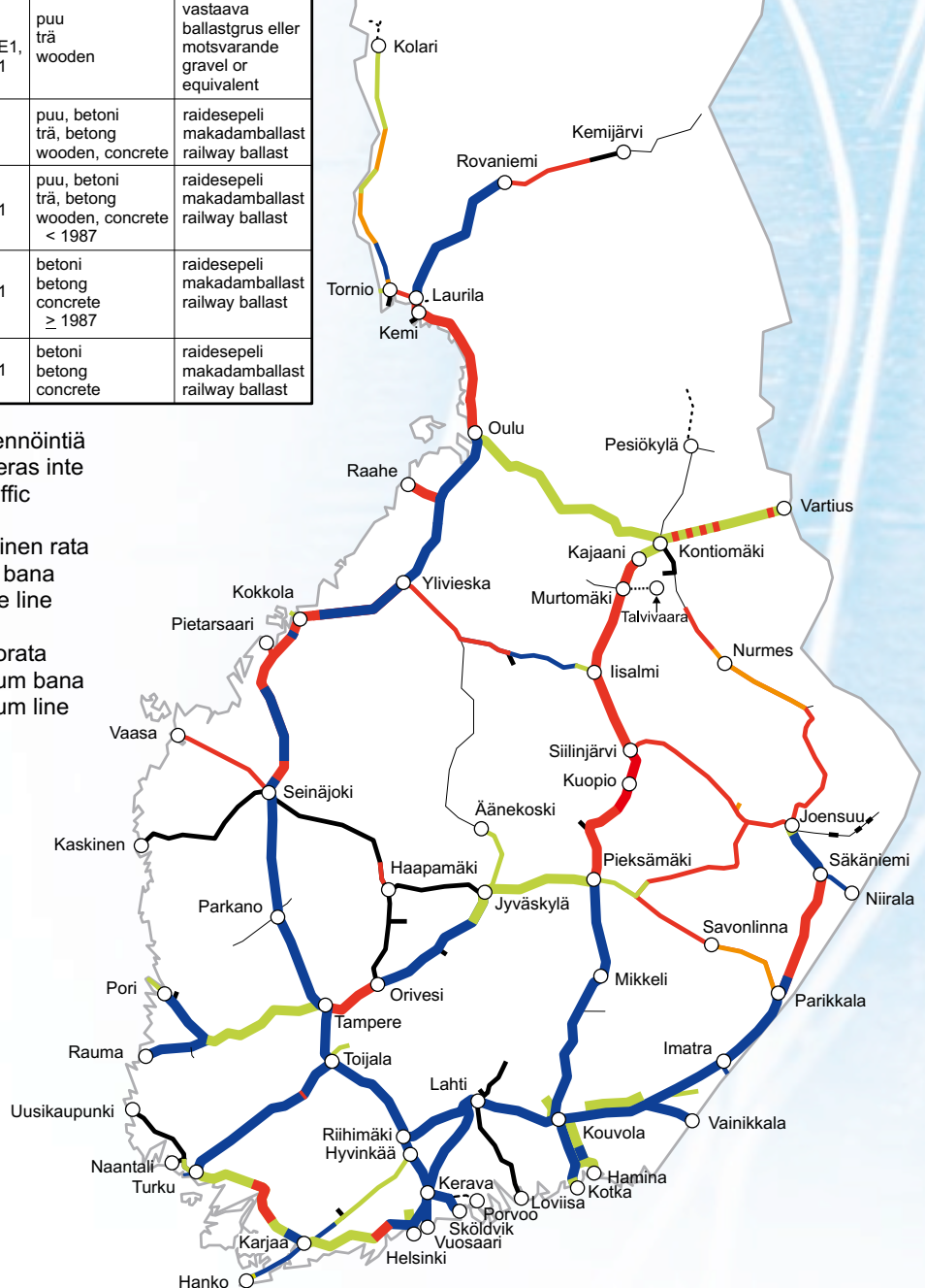
Kuva 1. Rataosien päällysrakenneluokat ja sähköistys
