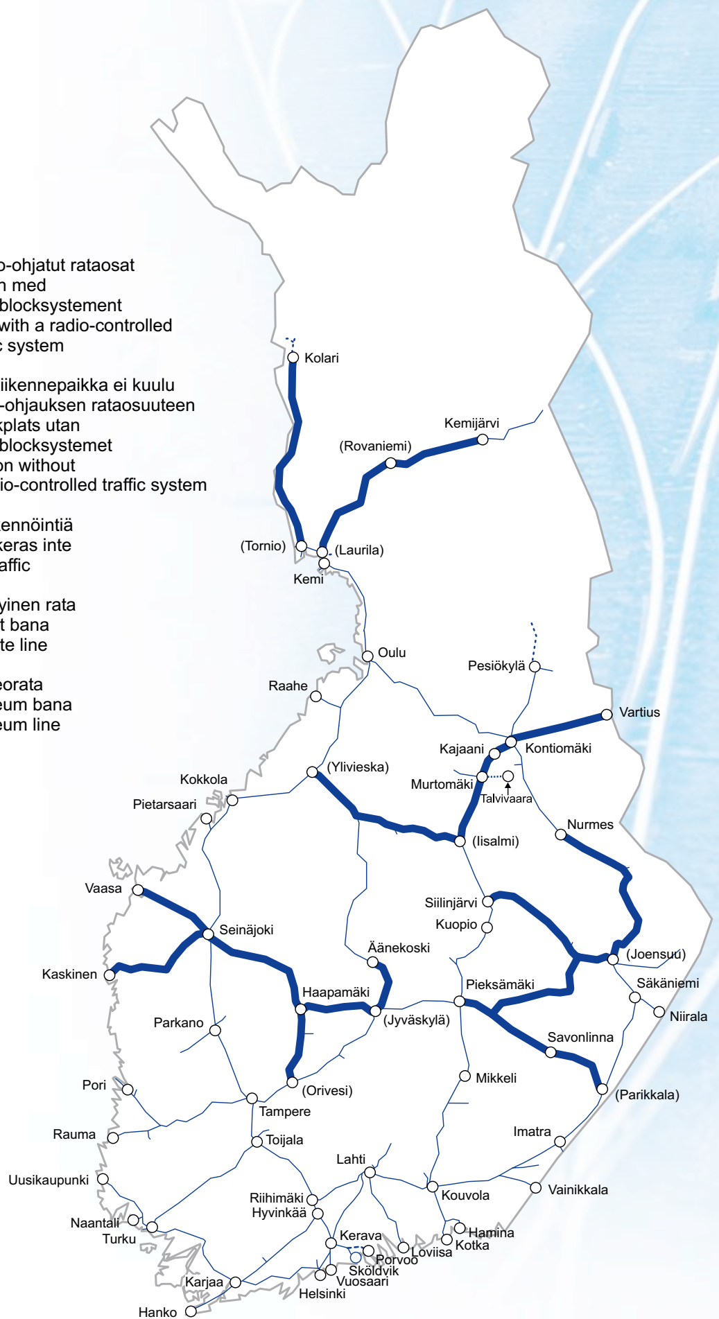
Kuva 4. Radio-ohjauksella varustetut rata-osat
