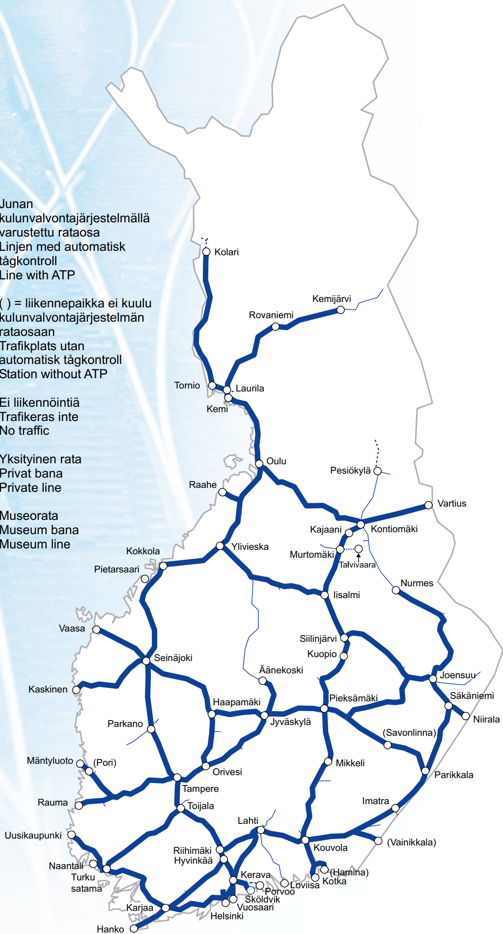
Kuva 3. Junan kulunvalvonnalla (JKV) varustetut rataosat
