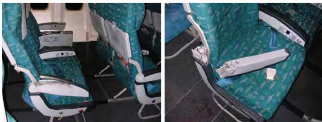
圖 1.12-1 乘客座椅扶手斷裂
