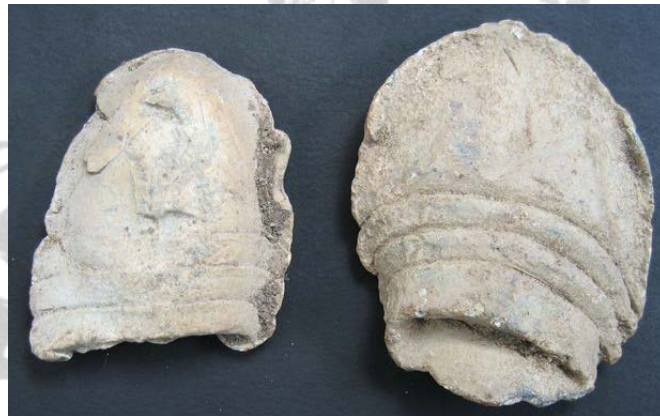
Kule zdeformowane po wystrzeleniu.
