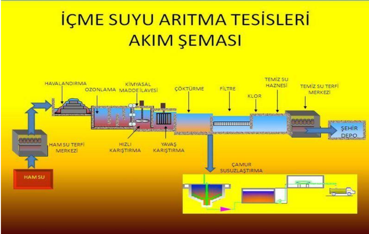
Şekil 1– Kars içme suyu arıtma tesisi akım şeması (Kars Belediyesi, 2014)
