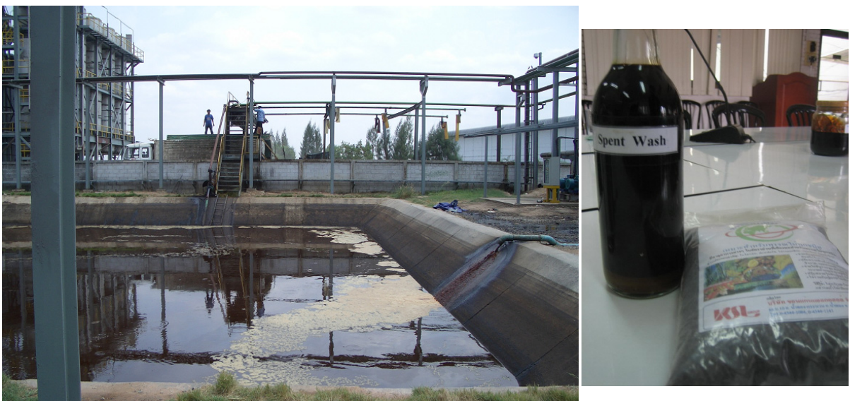
写真 2.14 エタノール工場からの排液と製造された肥料
