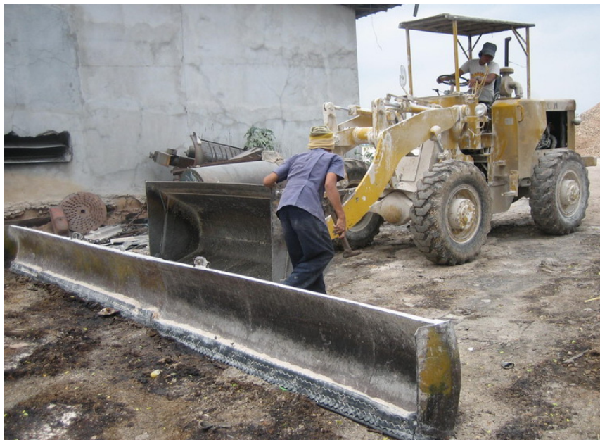
写真 3.14 乾燥後チップ収集用アタッチメント
