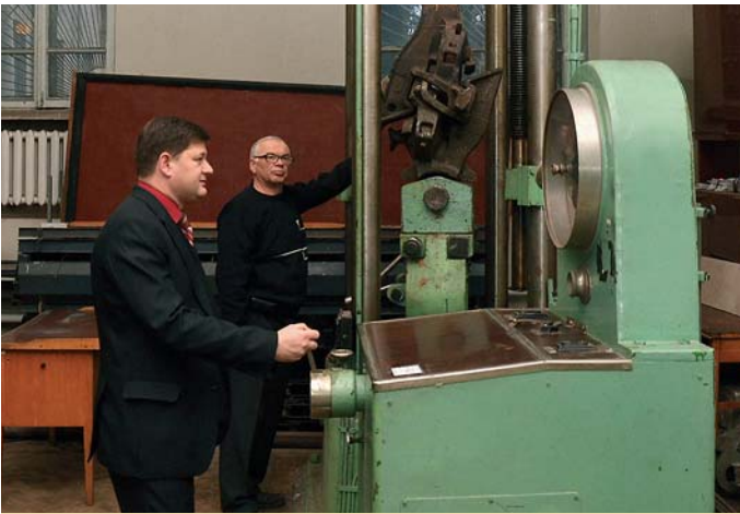
Тарування тензометричних автозчеплень СА-3. На фото: зав. лаб. Є. Ф. Федоров, ст. наук. співроб. А. К. Перцовий)
