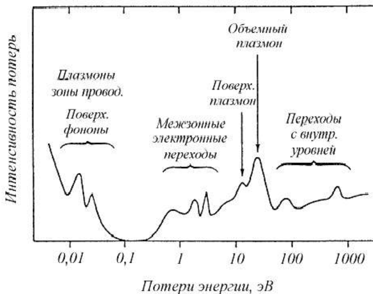
Рис. 3.69. Вид спектра характеристических потерь энергии электронов
