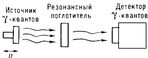
Рис. 3.63. Схема \gamma -резонансного спектрометра
