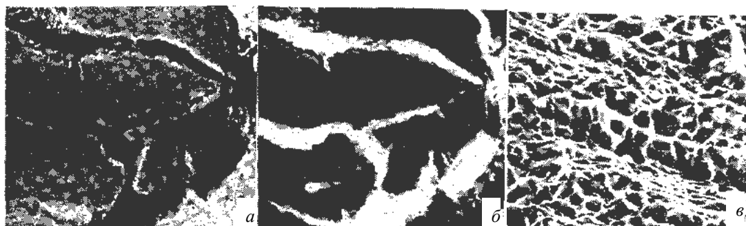
Рис. 9.2. Изображение поверхности в упругоотраженных (а), поглощенных (б) и во вторичных электронах (в): а, б – графитовые включения в сером чугуна ( X200 ; шлиф); в – рельеф поверхности излома нержавеющей стали ( X1350 )
