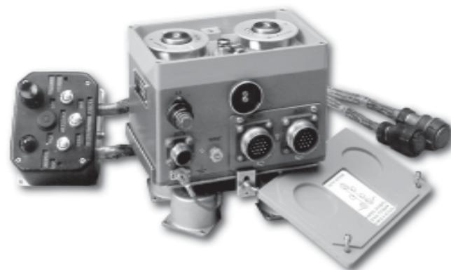
Бортовой магнитофон П-503Б для записи речи на магнитную проволоку («черный ящик»)
