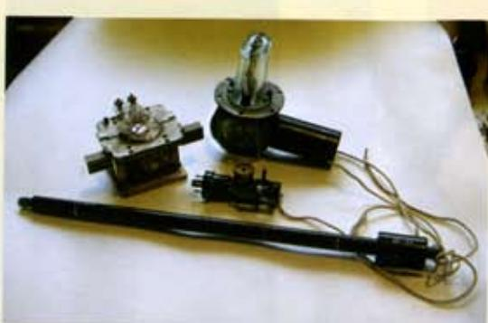
Шумовой диодный генератор в трехсантиметровом диапазоне
