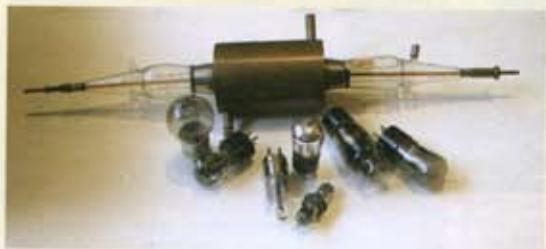
Первая 10 кВт генераторная лампа с наружным охлаждаемым анодом. 1922 год
