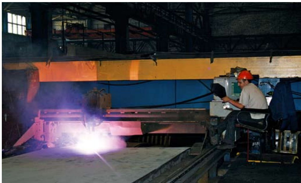
Плазменная резка на машинах с программным управлением типа «Кристалл»
