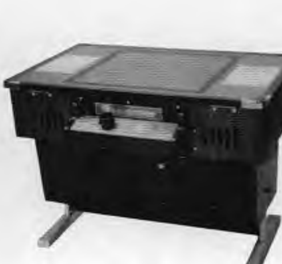
マージャンブロック・ジャンボウ (テーブルタイプ) ブロック崩しにより麻雀の役を作っていくというTVゲーム機。テーブル18.4型O.P.価格21万1千円。【SNK】No.303
